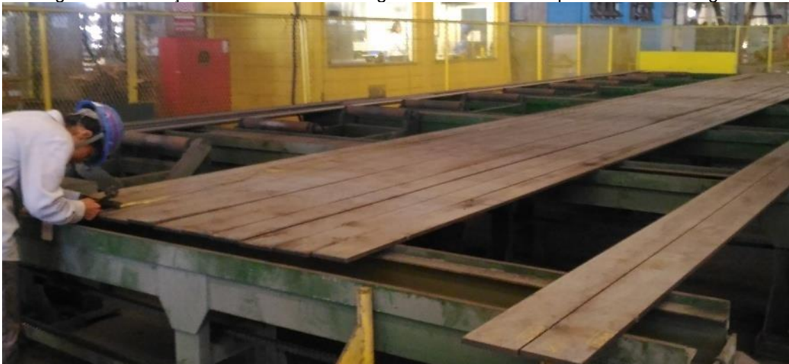
Figura 62 - Aferição dimensional dos flanges e almas antes do processo de soldagem.
