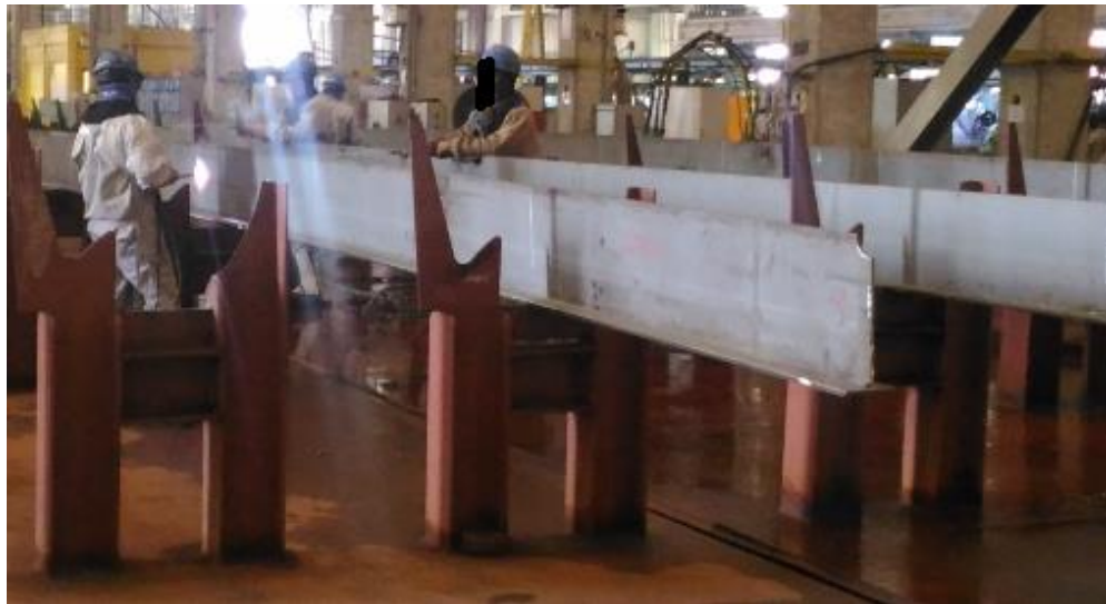
Figura 52 - Preparação de Flanges, tratamento de superfície.
