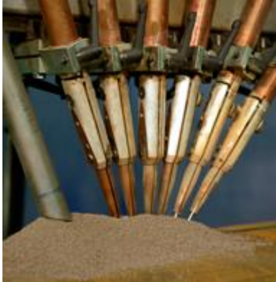
Figura 21 - Esquema de soldagem SAW por multiwire .
