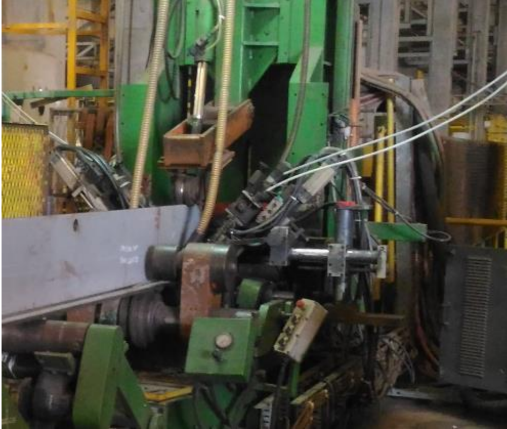
Figura 57 - Máquina Corimpex realizando a soldagem de perfis.
