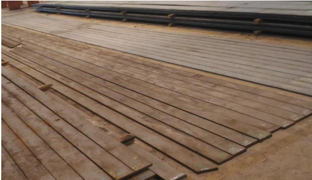
Figura 47 - Buffer intermediário de almas e flanges cortados.
