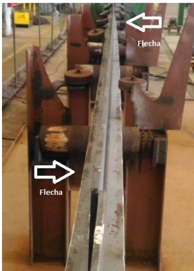
Figura 65 - Evidência de empenos dos perfis após a soldagem
