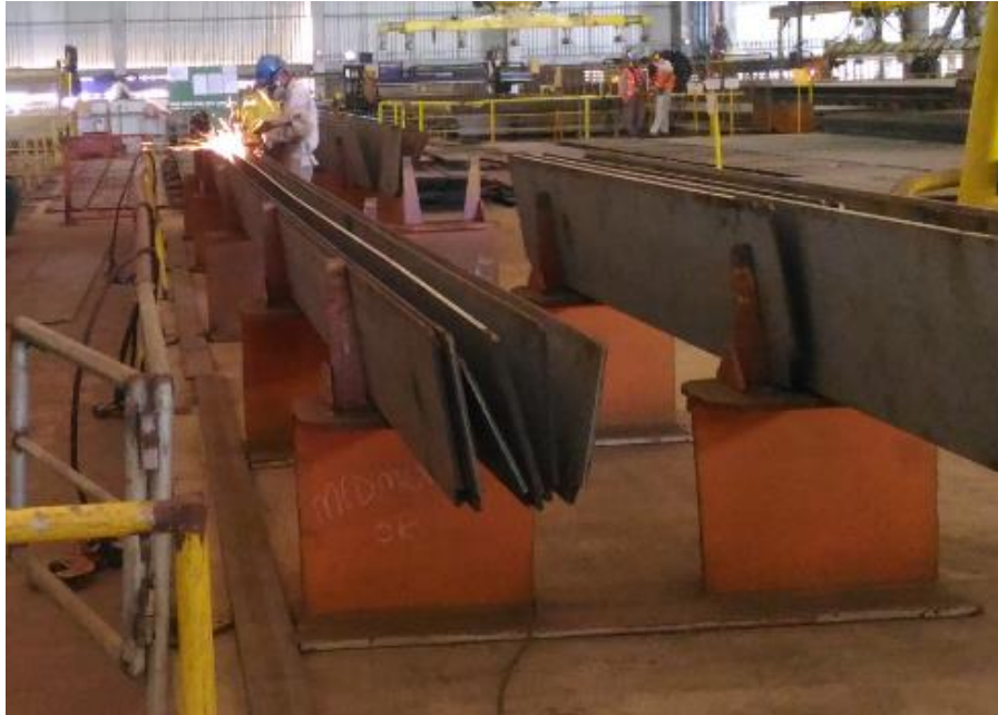
Figura 48 - Mesa de preparação de peças para iniciar o processo de montagem de perfis.
