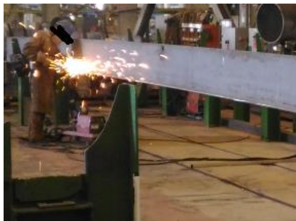
Figura 52 - Preparação de Flanges, tratamento de superfície.
