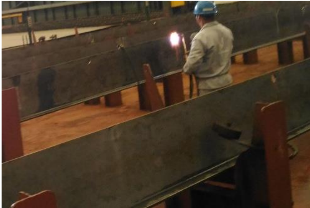
Figura 66 - Aplicação de linhas de calor para conformar os perfis.
