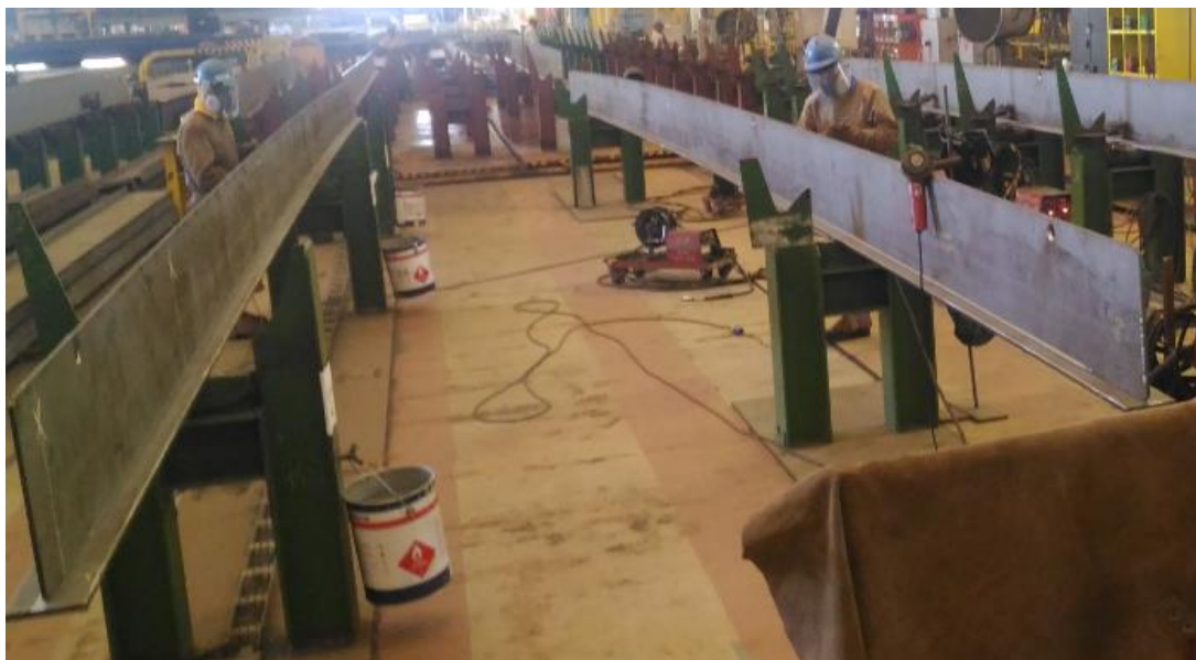
Figura 65 - Evidência de empenos dos perfis após a soldagem
