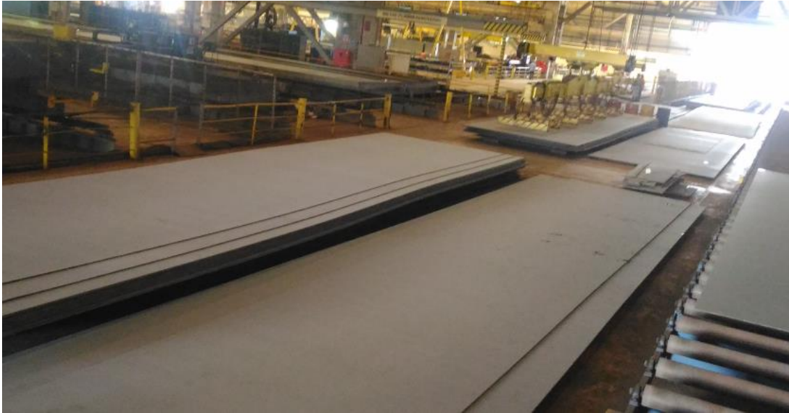
Figura 45 - Área de recebimento de chapas após o tratamento de superfície.
