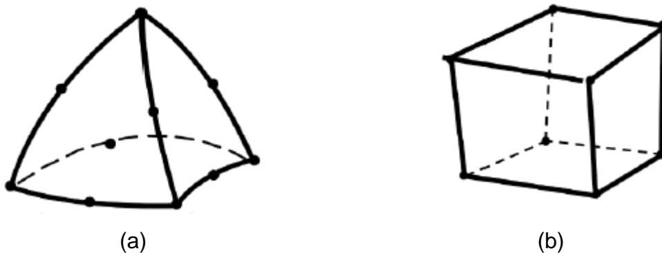
Figura 12 - Principais tipos de elementos: a) tetraédrico; b) hexaédrico
