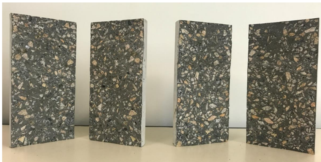
Figura 24 - Ruptura dos corpos de prova submetidos ao ensaio de tração por compressão diametral.
