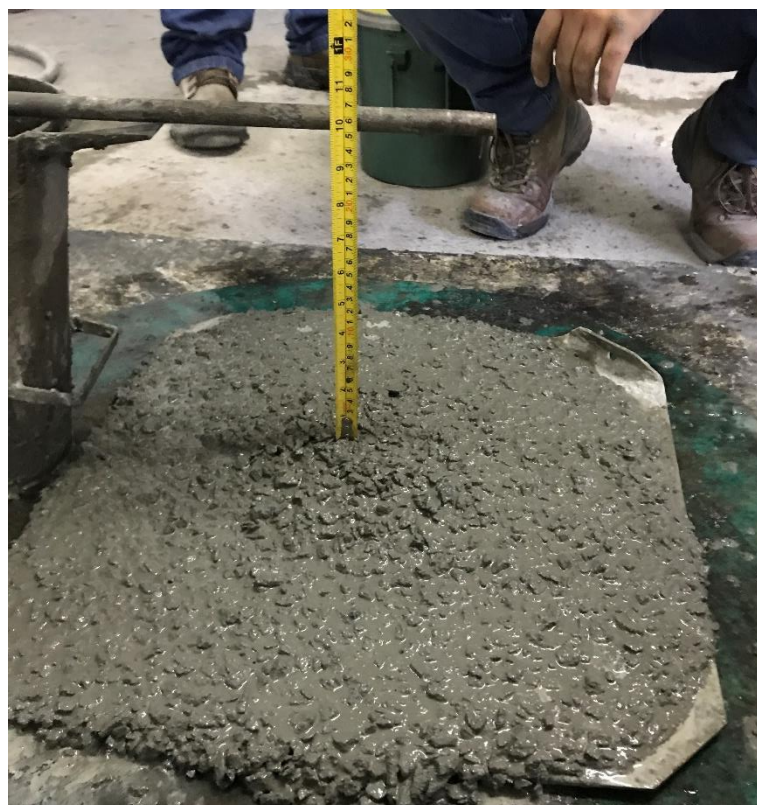
Figura 18 - Medição do abatimento do concreto.
