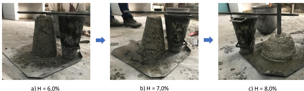
Figura 30 - Consistência do traço rico de CEAA com a) H = 6,0%, b) H=7,0%, c) H = 8,0%.
