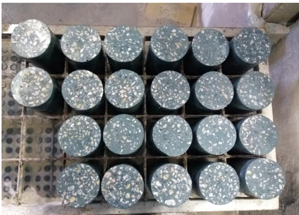
Figura 17 - Retificação das bases dos corpos de prova.
