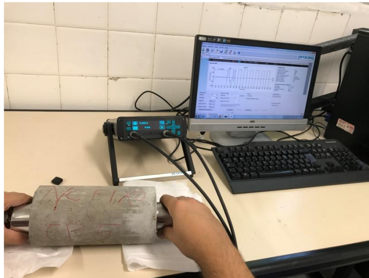
Figura 21 - Execução do ensaio de determinação da velocidade de propagação de onda ultrassônica.
