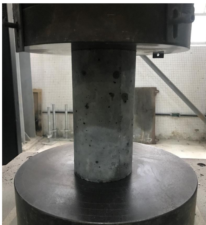
Figura 20 - Ensaio de resistência à compressão.
